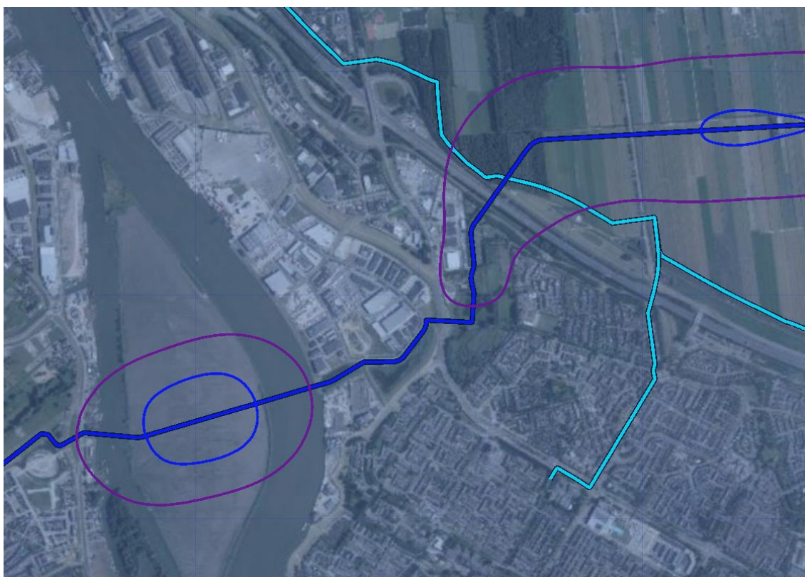
Afbeelding 4.3: Plaatsgebonden risico voor gasleiding A-555
