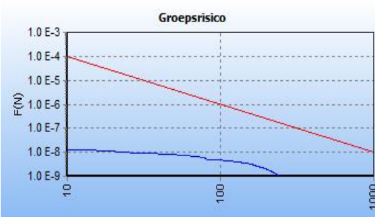
Afbeelding 4.6: FN-curve (blauwe lijn) van de maatgevende kilometer afgezet tegen de oriëntatiewaarde (rode lijn) in de huidige situatie (links) en plansituatie (rechts)
